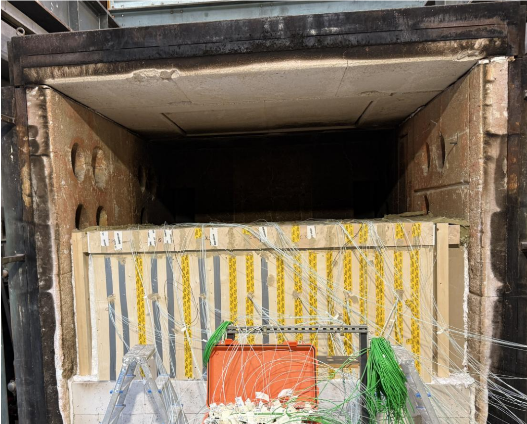
Abbildung 2 Brandabgewandte Seite eingebaute Probekörper vor Versuchsbeginn Figure 2: Fire-unexposed Side of installed Test Specimens before Testing
