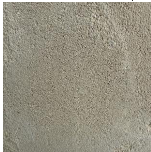
e \rho = 2000 \text{ kg/m}^3 Baustoffklasse A1 DIN 18947 - 0/0,5 m - SII - 2,0 - A1
