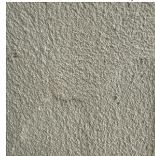
f \rho = 1400 \text{ kg/m}^3 Baustoffklasse A1 DIN 18947 - 0/1 f - SII - 1,4 - A1
