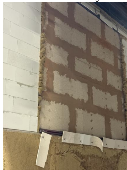
Ansicht der intakten brandzugewandten Seite der Konfiguration \gamma\gamma nach Versuchsdurchführung
