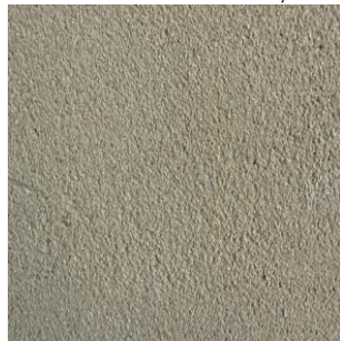
d \rho = 1800 \text{ kg/m}^3 Baustoffklasse A1 DIN 18947 - 0/1 - SII - 1,8 - A1
