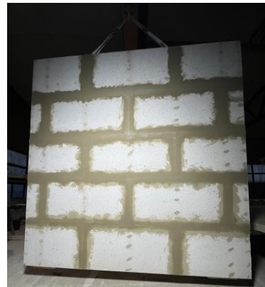
Brandzugewandte Seite Konfiguration \gamma\gamma nach Fugenverstrich
