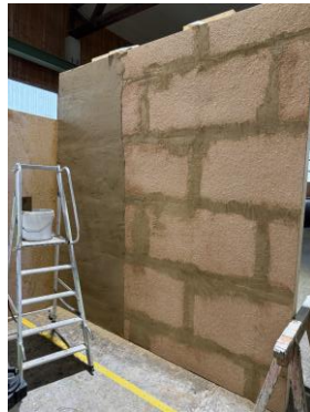
Brandzugewandte Seite Konfiguration \alpha\alpha während Verputzen
