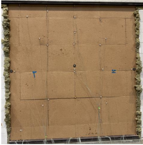
Ansicht brandabgewandte Seite Konfiguration \alpha\alpha vor Versuchsdurchführung
