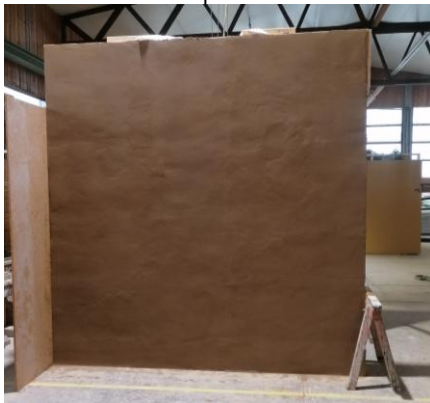
Brandzugewandte Seite Konfiguration \alpha\alpha nach Verputzen
