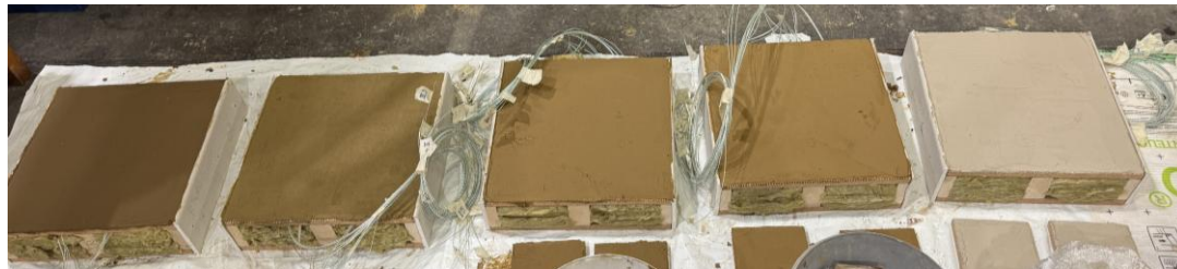
Prüfkörper nach Verputzen (von links βα, αα, δα, εα, φα)
