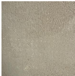
b \rho = 1800 \text{ kg/m}^3 Baustoffklasse A1 DIN 18947 - 0/1 m - SII - 1,8 - A1
