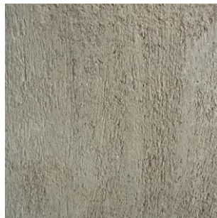
a \rho = 1800 \text{ kg/m}^3 Baustoffklasse: A1 DIN 18947 - 0/1 f - SII - 1,8 - A1
