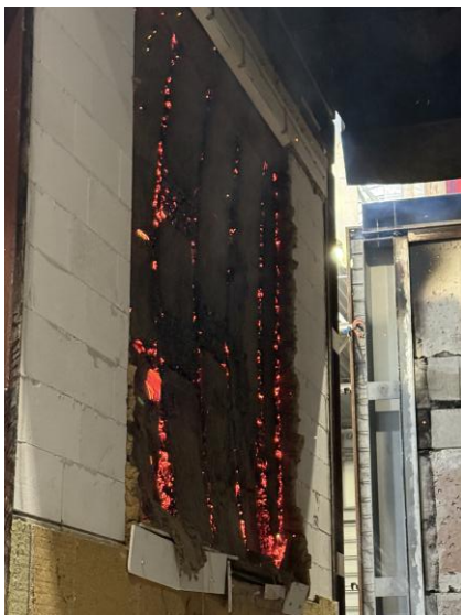
Ansicht der abgefallenen Lehmplatten auf brandzugewandte Seite der Konfiguration \alpha\alpha nach Versuchsdurchführung
