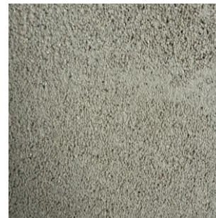
c \rho = 2000 \text{ kg/m}^3 Baustoffklasse A1 DIN 18947 - 0/1 f - SII - 2,0 - A1
