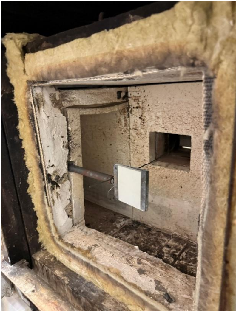
Abbildung 1 Brandraum vor Prüfung Figure 1 Furnace chamber before testing
