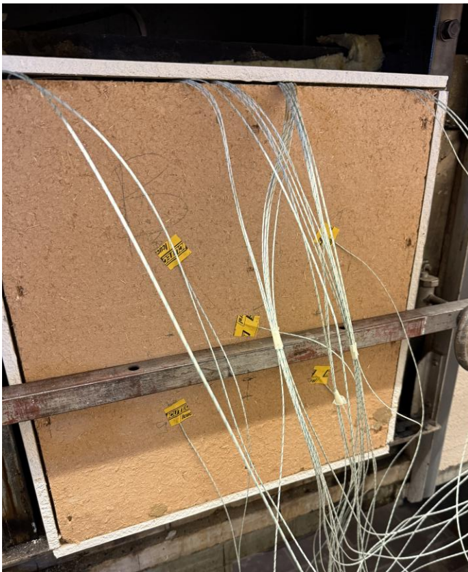
Abbildung 3 Brandabgewandte Seite eingebaute Probekörper vor Versuchsbeginn Figure 3 Fire-unexposed Side of installed Test Specimens before testing
